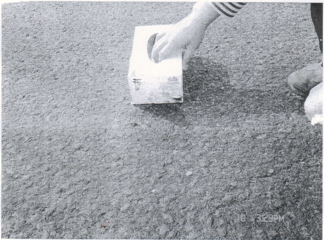
附图 4 汽油渗入原有沥青路面
